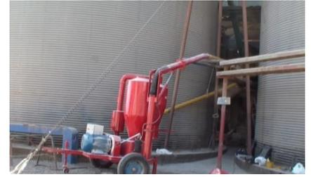
**Vaciado de silo, reemplazando roscas barredoras. Succion 20 mts y expulsión a 28mts – 50Hp**
